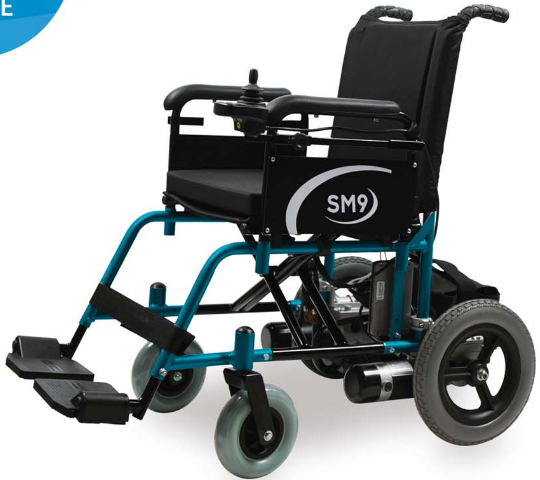
Motor com tração por redução e freio eletromagnético acoplado
